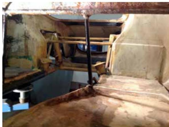
Blick aus dem Fahrgastraum in den leeren Motorraum. Die beiden sicher nicht originalen Karton-Glasfasergebilde im Fussraum sind demontiert.
