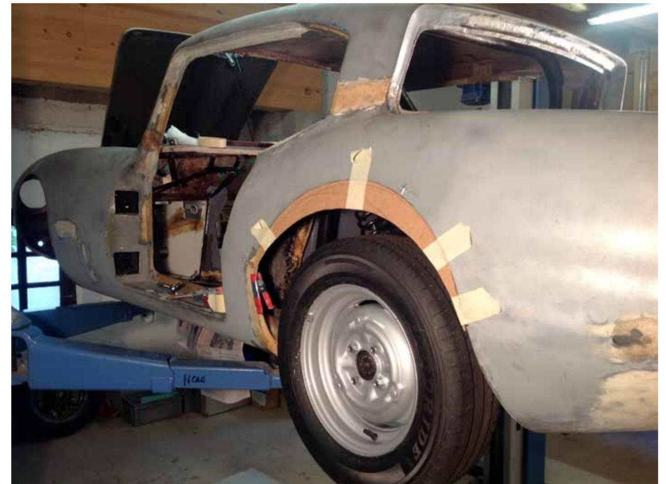
Dachabschluss hinten, ähnlich wie bei Ford Anglia oder Citroën Ami 6. Radausschnitt: Dieser wurde von einem Vorgänger vergrössert. Da nun aber die Achse, bzw die Räder über die Karosserie hinausragen, muss der Ausschnitt zumindest teilweise rückgebaut werden. Im Moment bin ich auf «Formensuche».
