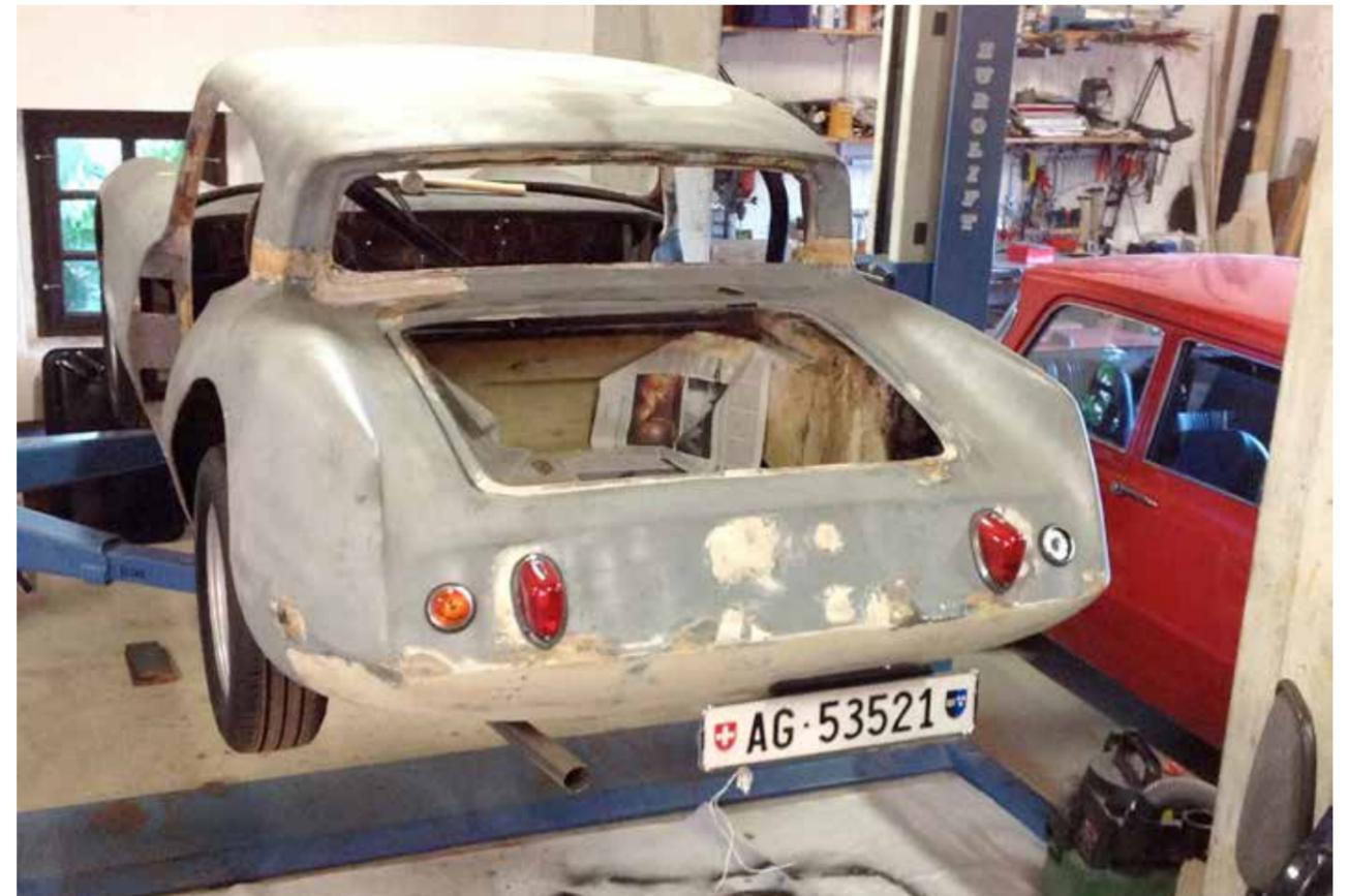
ELVA von hinten mit prov. montiertem Auspuff, Rückleuchten, Blinker und Nummernschild.
