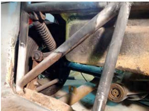
Blick aus dem Fahrgastraum auf die Hinterachse. Der wahrscheinlich nicht originale Überrollbügel wurde belassen, die beim Kauf nur teilweise vorhandene Rückwand mittlerweile neu erstellt.
